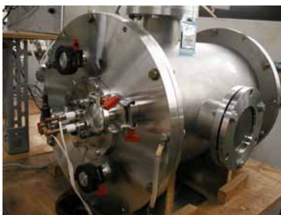
Figura 5- Câmara para Implantação Iônica por Imersão em Plasma (3IP)
