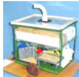
**M9** - Temos a proposta atual, utilizando os princípios do modelo anterior e com dispositivos para viabilizar as operações de carga,descarga, secagem e hogeneização da massa de grãos.A mobilidade do equip. é mantida.(2003)
