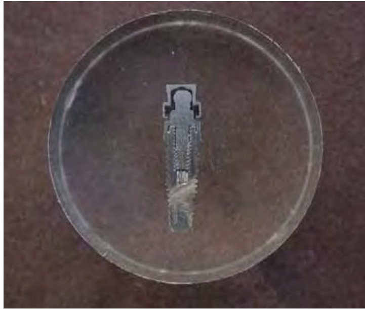
FIGURA 12 – Conjunto esférico após secção em recortador, possibilitando visualização dos passos de rosca, da superfície interna e da adaptação entre os componentes e os implantes.
