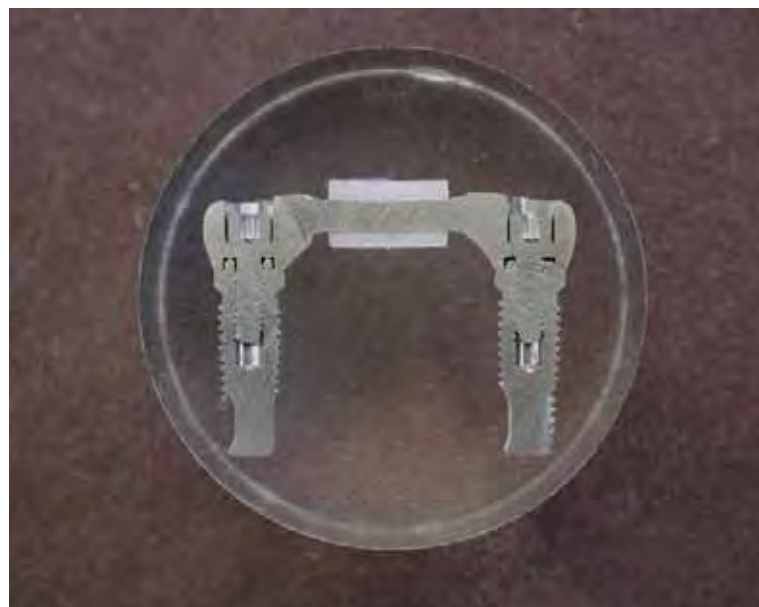
FIGURA 11 – Conjunto barra-clipe após secção em recortadora, possibilitando visualização dos passos de rosca, da superfície interna e da adaptação entre os componentes e os implantes.
