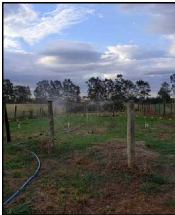
Figura 17. Teste de CUC (Coeficiente de Uniformidade de Christiansen) realizado no sistema de irrigação utilizado no cultivo do quiabo.
