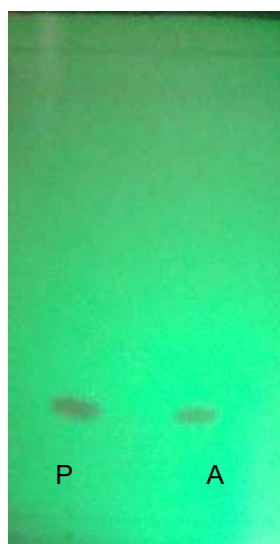
Figura 10: Determinação de cefuroxima sódica 10 mg/mL por cromatografia em camada delgada, P: SQR e A: amostra. Sistema solvente: clorofórmio: metanol: ácido fórmico (18:2:1)
