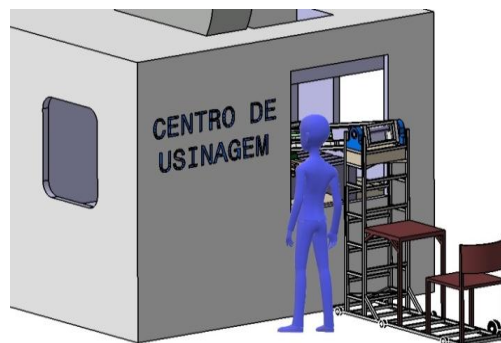
Figura 29 – Escala real do alimentador de matéria-prima para um centro de usinagem três eixos.
