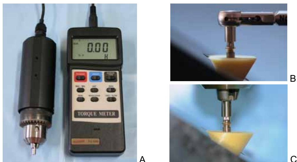
Figura 23 – A) Torquímetro digital utilizado; B) Instalação dos pilares com torquímetro manual; C) Aplicação do torque de aperto com torquímetro digital.
