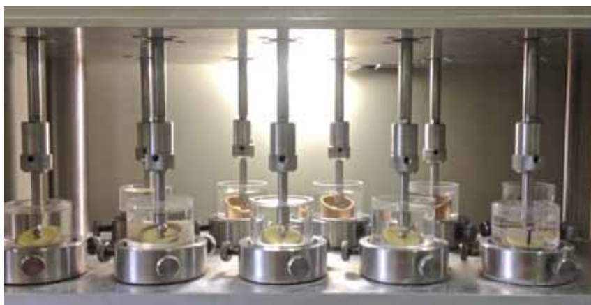
Figura 25 – A) Simulador de Fadiga Mecânica (Erios) utilizada; B) Conjuntos fixados ao dispositivo rígido de fixação da cicladora mecânica.
