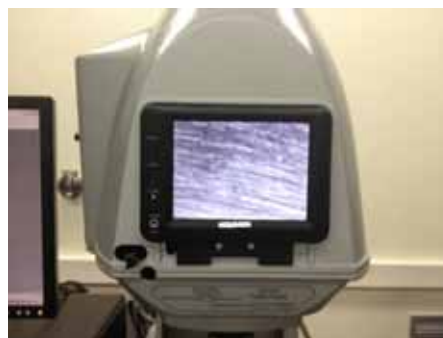
Figura 10 – A) Perfilometria óptica sendo realizada sobre o substrato; B) imagem exibida no monitor do perfilômetro durante a análise.
