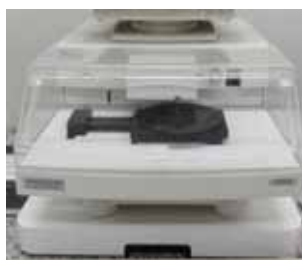
Figura 11 – Perfilômetro utilizado para medir a espessura dos filmes de DLC.
