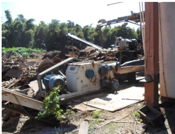
Figura 6. Picador de madeira modelo PPK220/500 da marca Planalto, série 0457/02, com potência de 60 a 175 cv e capacidade de 34 mst/h.
