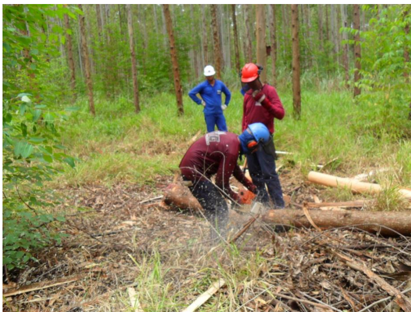
Figura 3. Medição dos diâmetros e retirada de discos nas alturas de 0%, DAP, 25, 50, 75 e 100% da altura comercial de cada árvore.
