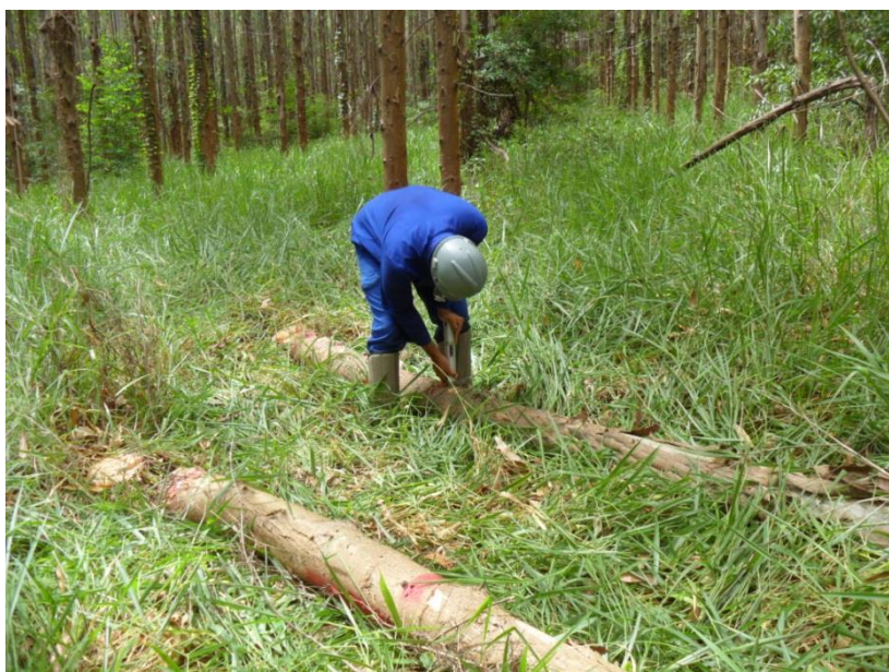
Figura 10. Uso do equipamento Pilodyn nas alturas de retirada dos discos.
