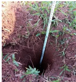
Figura 11. Identificação da profundidade do solo com uso de uma trena
