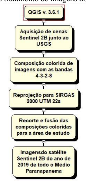
Figura 8 - Fluxograma do processo do tratamento de imagens do satélite Sentinel 2B para a UGRHI 17.
