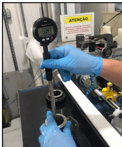
Figura 24 – Medição do diâmetro com relógio comparador
