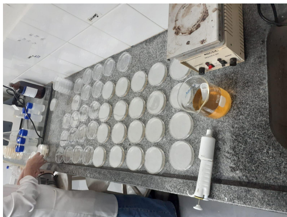
Figura 7 - Emplacamento de meio de cultura Agar Chromocult® Coliformes
