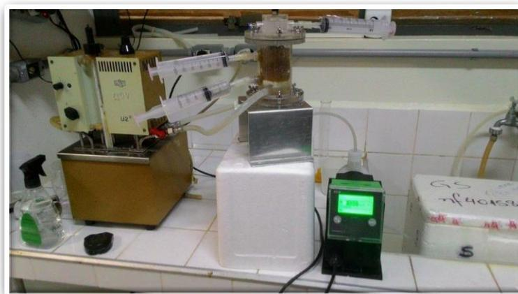
**Figura 6.** Reator enzimático de leito fixo e modo de operação contínuo com fluxo ascendente com bomba de alimentação e banho termostatizado acoplados. Fonte: Próprio autor.
