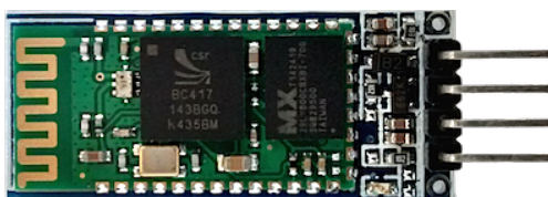
Figura 8: Módulo Bluetooth BC 417 HC-06
