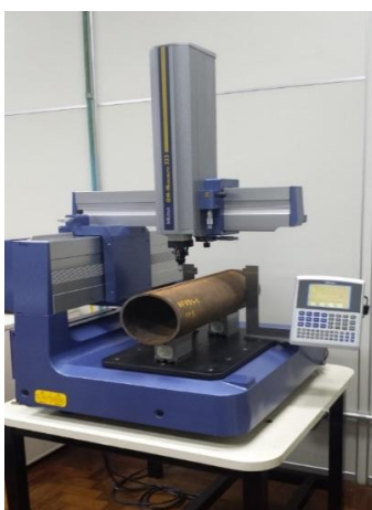
Figura 83 — Anel de 600 mm seccionado longitudinalmente posicionado no equipamento de medição.
