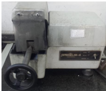
Figura 59 – Equipamento para corte abrasivo PRAZIS COR 40.
