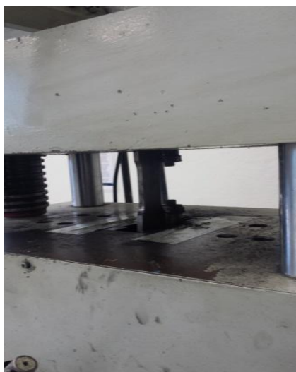
Figura 68 – Corpo de prova posicionado para o ensaio de tração.
