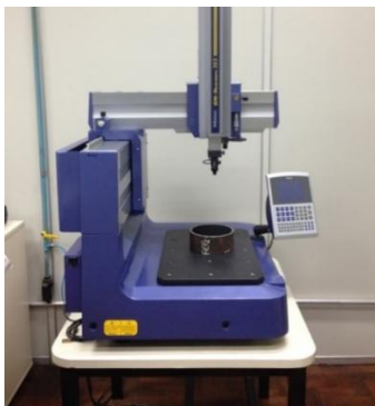
Figura 82 - Anel sem corte posicionado no equipamento tridimensional.
