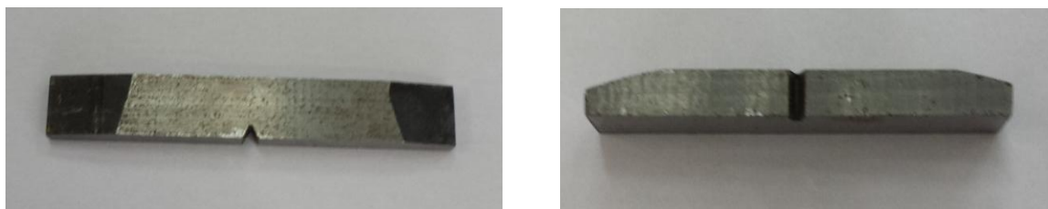
Figura 71 – Corpo de prova Charpy “V” produzido.
