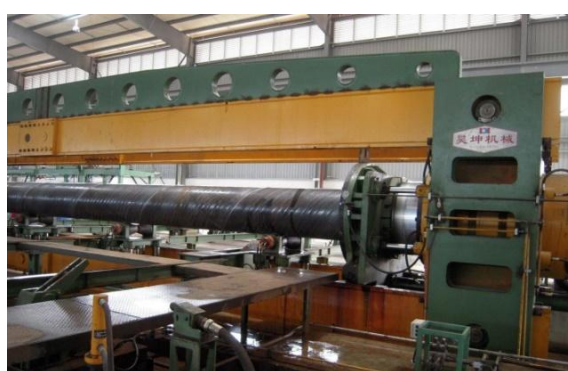
Figura 36 –Equipamento de teste hidrostático
