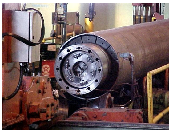
Figura 34 – Tubo sendo expandido.
