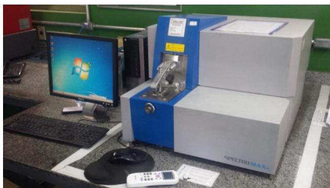
Figura 58 – Aparelho de espectrometria de emissão ótica SPECTRO MAXX 2007.
