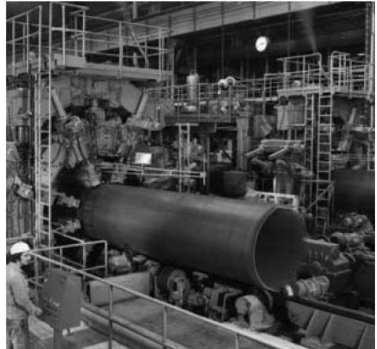
Figura 31 – Tubo em processo de “selagem”.
