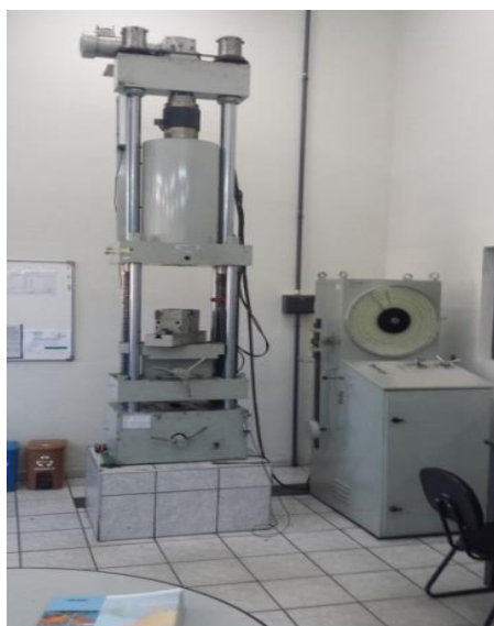
Figura 65 – Equipamento de ensaio de tração KRATUS – 100 tf.
