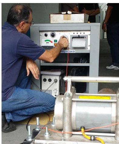
(a) Determinação da frequência de ressonância.
