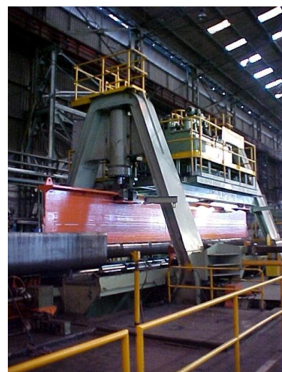
Figura 27 - Prensa U-Extração da peça.
