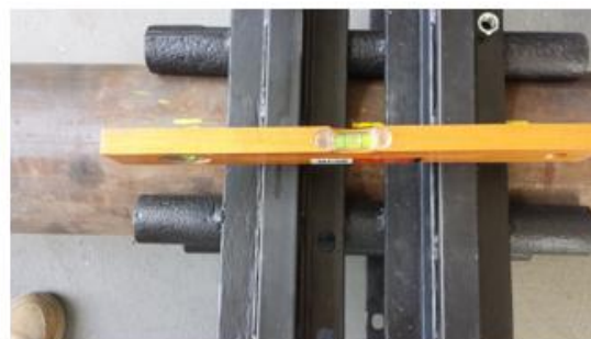
(D) Nivelamento transversal do dispositivo
