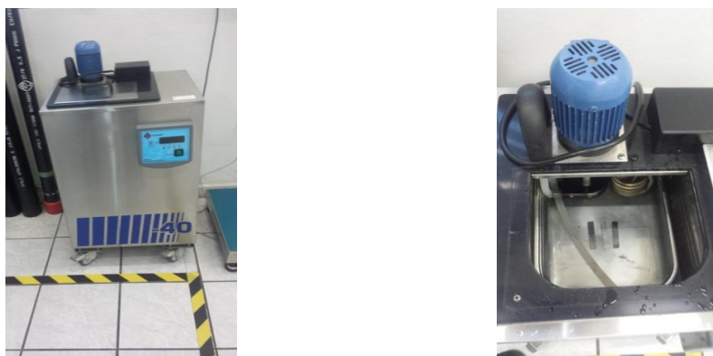
Figura 72 – Refrigerador elétrico QUIMIS ULTRATERMOSTÁTICO.
