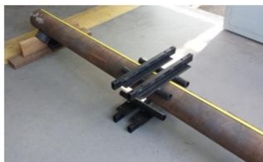
(B) Posicionamento do tubo nos suportes amortecedores.
