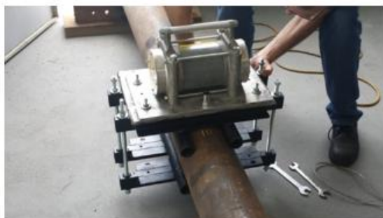
(E) Montagem do indutor de vibração no dispositivo.
