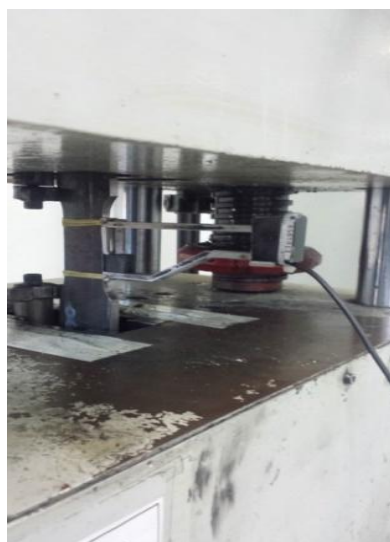
Figura 69 – Fixação do extensômetro de corpo duplo no corpo de provas.
