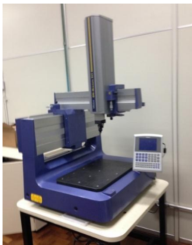
Figura 81 – Equipamento de medidas tridimensional para medição dos anéis.
