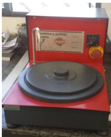
Figura 60 – Equipamento para corte abrasivo FORTEL PLF para lixamento e polimento.
