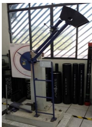
Figura 73 – Máquina de impacto para ensaio Charpy PAN 300J.
