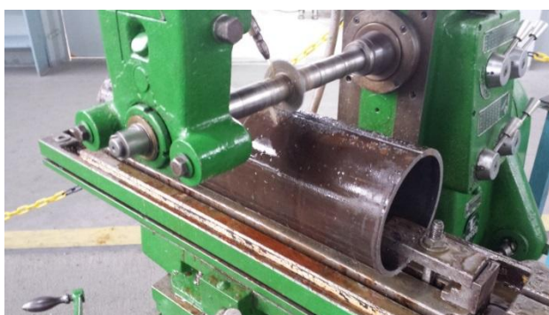
(b) longitudinal dos anéis em fresadora de disco.
