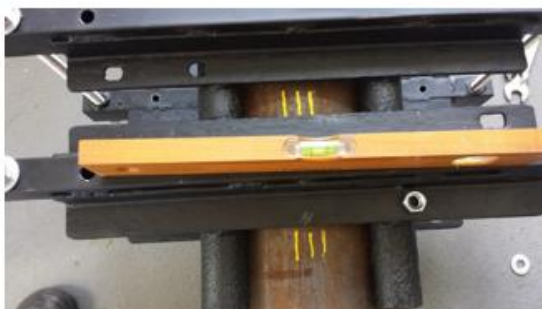
(C) Nivelamento longitudinal do dispositivo.
