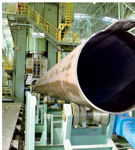
Figura 29- Retirada do tubo do interior da prensa “O”.
