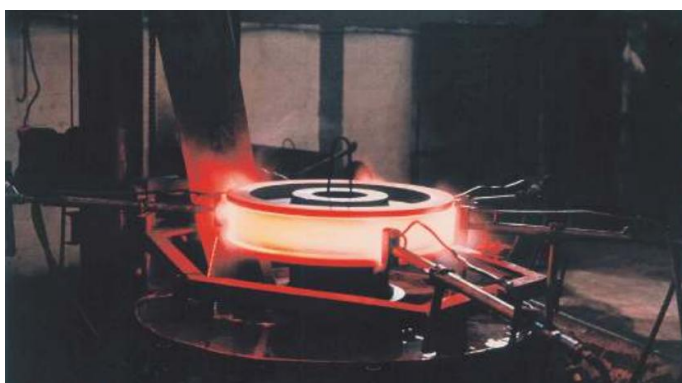
Figura 4 - Têmpera de uma engrenagem feita por chama.
