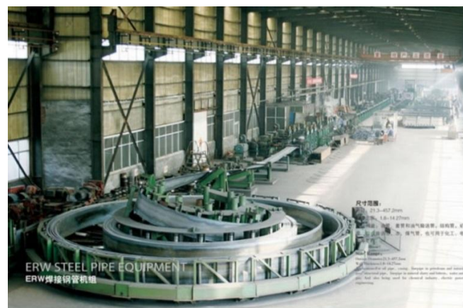
Figura 40 - linha ERW completa com stand de rolos ajustáveis e pulmão de chapas.
