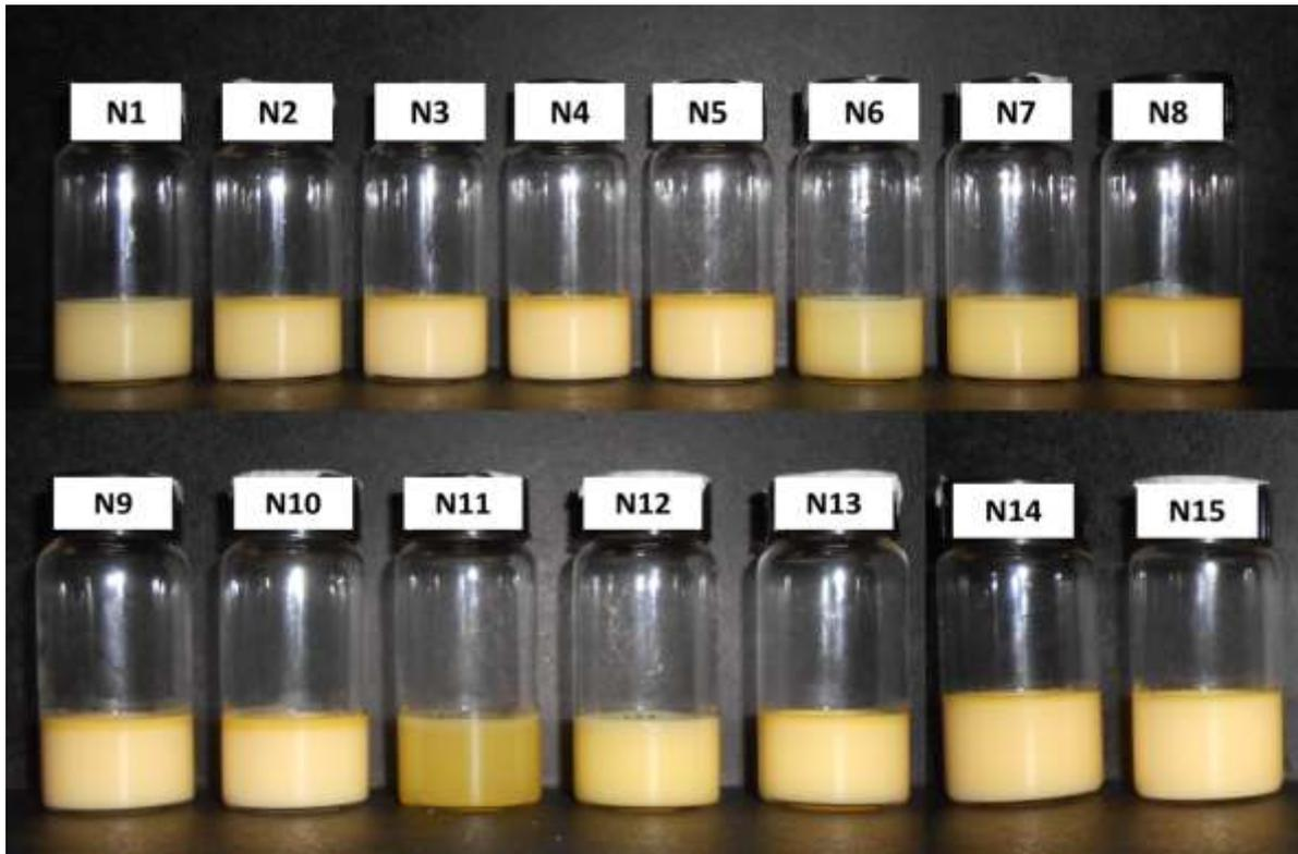
**Figura 52.** Formulações obtidas nos pontos intermediários N1 a N15 do diagrama pseudoternário, após 24 horas em repouso (Própria autora).
