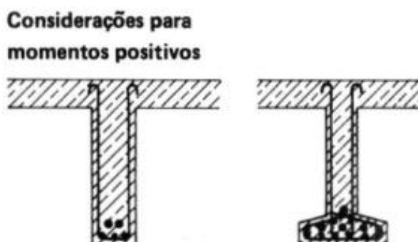
Figura 8.1 – Análise de momentos positivos para uma viga de concreto armado
