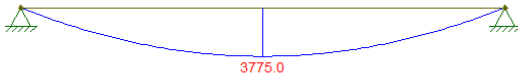
Figura 51 – Diagrama de momento fletor das ações permanentes no ELS
