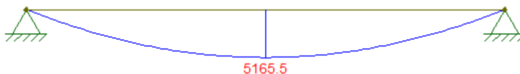
Figura 45 – Diagrama de momento fletor das ações permanentes no ELU
