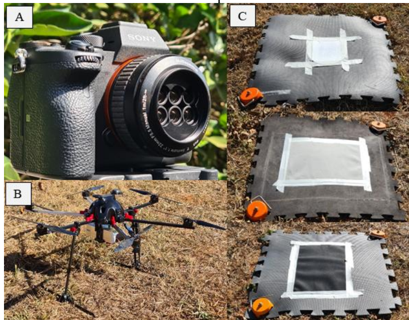
Figura 20 – Estratégia para coleta de dados multiespectrais aéreos. Em (A) a câmera Agrowing com seis cabeças de lentes ópticas, em (B) o veículo aéreo não tripulado, e em (C) os alvos das cores branco, cinza e preto, fixados em campo para realização da calibração por linha empírica.
