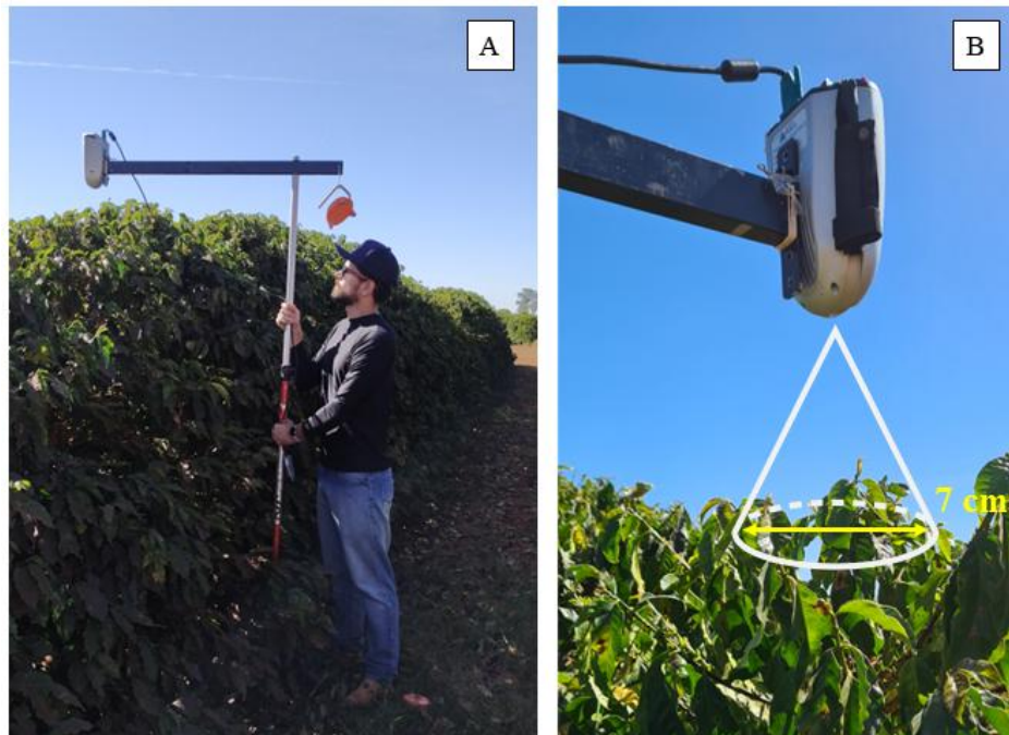
Figura 19 - (A) Aquisição dos dados hiperespectrais de um dossel de cafeeiro (B) o IFOV utilizado.
