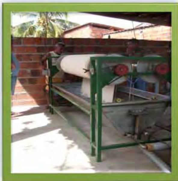
Foto 13 – Vista lateral da máquina para tingimento nas MPMEs de tecelagem de Jaguaruana. Fonte: pesquisa de campo, 2011.
