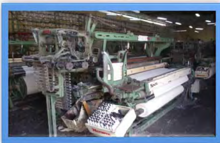
Foto 05 – Vista de um tear do tipo lançadeira (com uso de espuladeiras). Fonte: pesquisa de campo, 2011.
