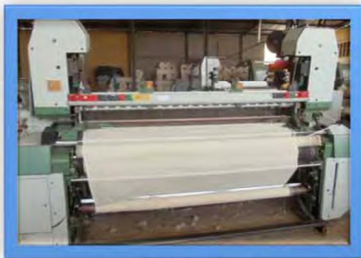
Foto 06 – Vista de um tear do tipo pinça (sem uso de espuladeiras). Fonte: pesquisa de campo, 2011.
