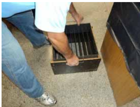
Figura 7: Foto da caixa formadora do colchão
