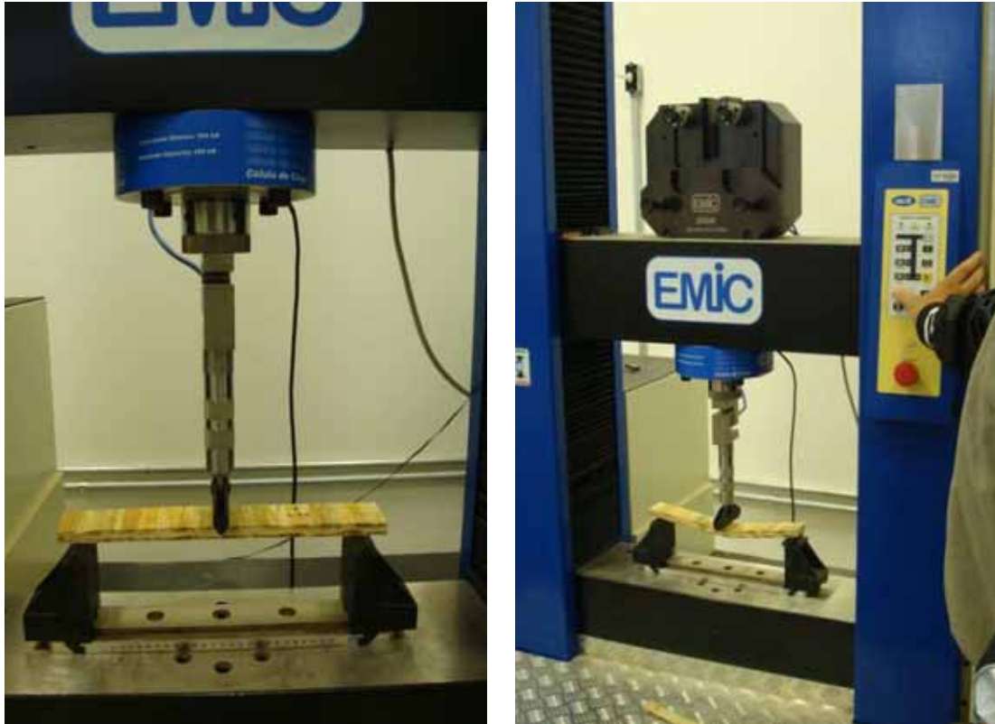
Figura 12: Realização do ensaio de flexão estática.
