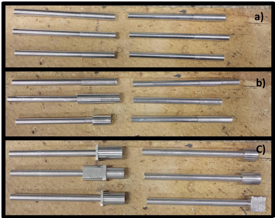
Figura 10. Corpos de prova usinados com direção de laminação a) 0° b) 45° c) 90°
