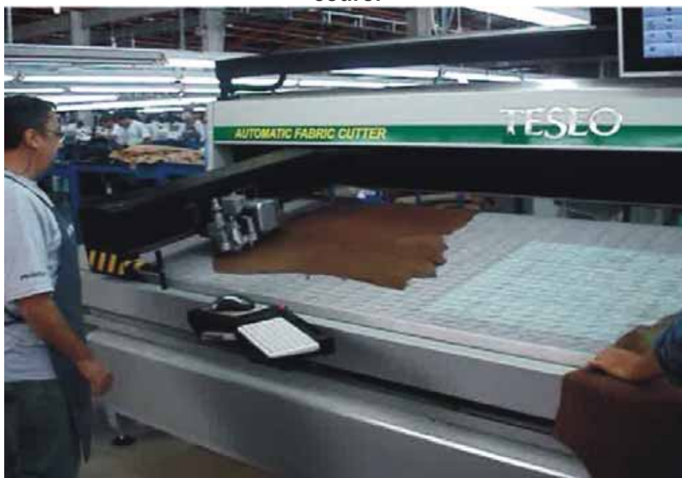
FIGURA 10: Máquina de Corte Automática baseada em CAD/CAM: cortando o couro.
