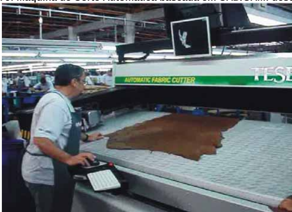
FIGURA 9: Máquina de Corte Automática baseada em CAD/CAM: desenhando.
