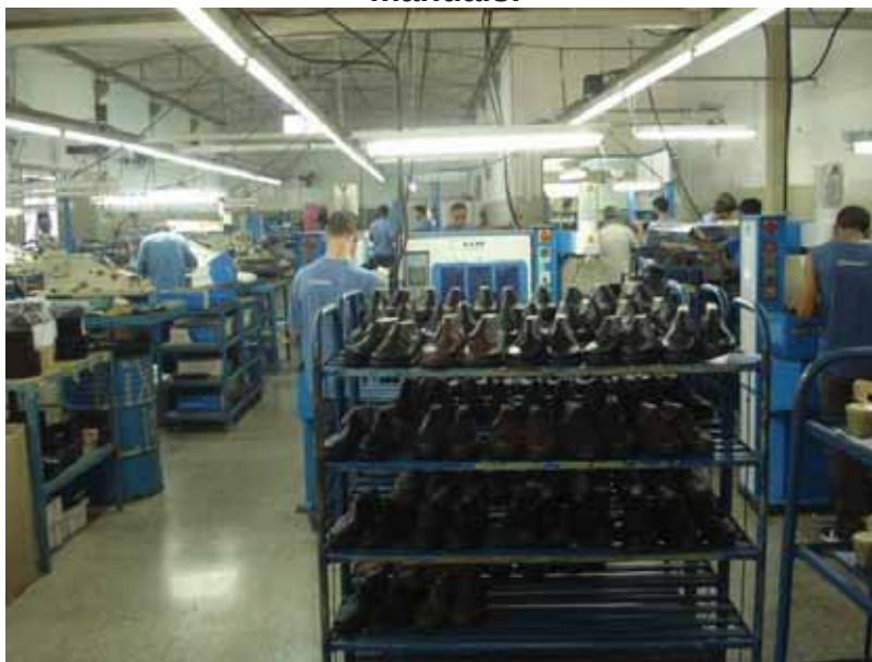
FIGURA 6: Vista Interna da fábrica: sem esteiras e com transportadoras manuais.
