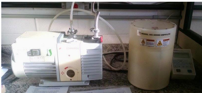
Figura 7- Equipamento spin coating onde foram depositados os filmes.
