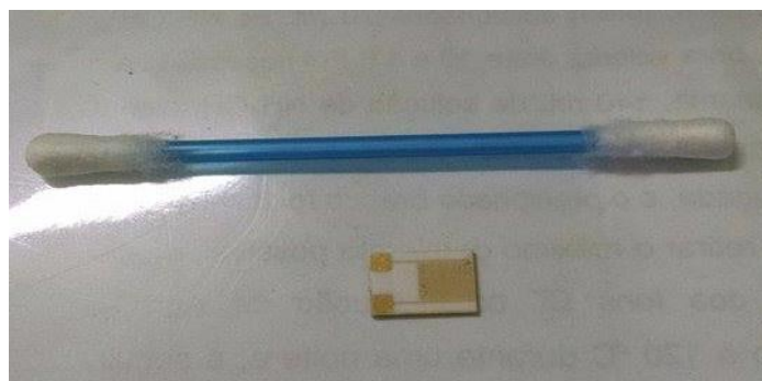
Figura 8 – Tamanho do substrato com trilha resistiva em comparação a uma haste flexível.
