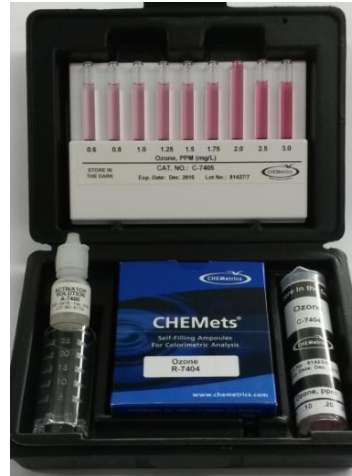
Figura 2- Conjunto colorimétrico CHEMets® KIT Ozone (K-7404).
