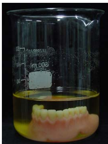
FIGURA 8 - Prótese total contaminada após 24 horas de incubação a 37°C.
