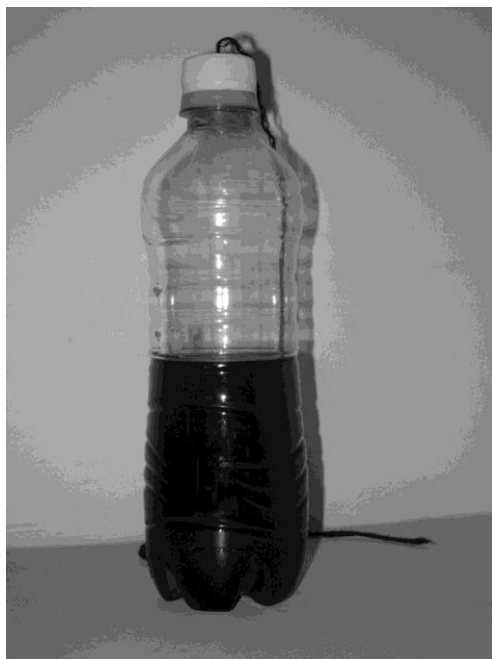
Ilustração 1: Garrafa com água (e corante) parada utilizada para mostrar a experiência do Balde de Newton. A superfície da água é plana.
