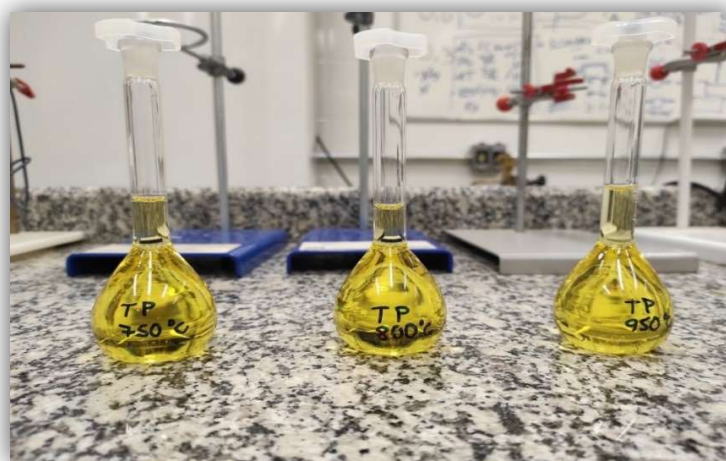
Figura 20 – Desenvolvimento do complexo de ácido Vanadomolibdofosfórico de coloração amarela após 10 minutos.
