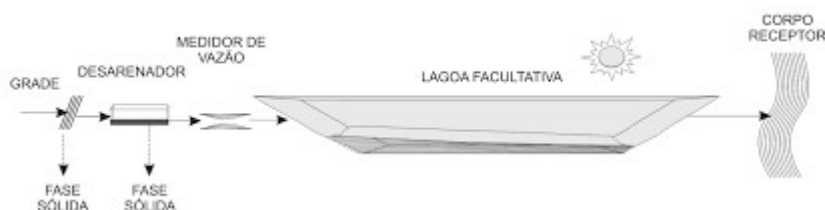
Figura 6 – Esquema de tratamento lagoa facultativa.
