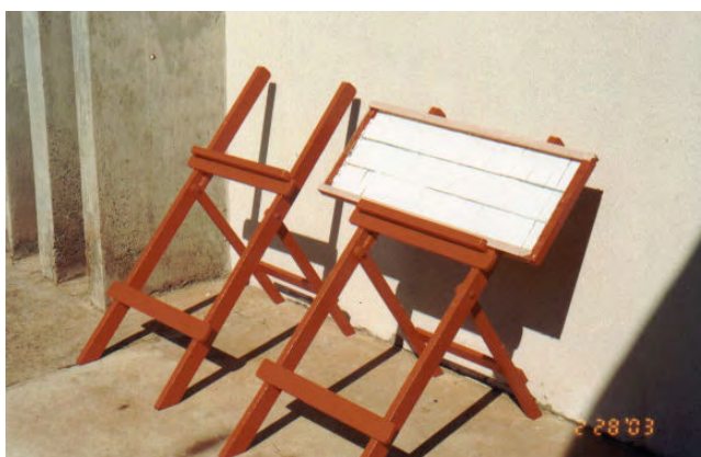
Figura 3: Amostras das diferentes tintas (A, B e C) aplicadas em placas de vidro no suporte para exposição à radiação solar.
