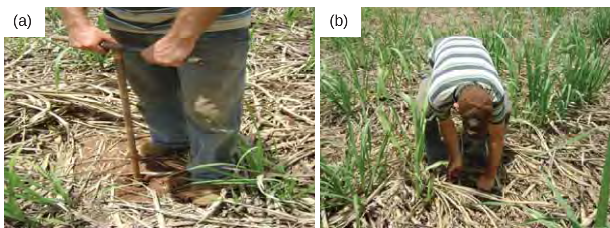
Figura 7- Detalhe da amostragem de solo (a e b) com uso de trado holandês realizado a 10 cm de distância da linha das soqueiras da cana-de-açúcar.
