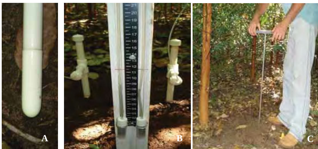
Figura 1. Cápsula porosa (A), Suporte do manômetro de mercúrio (B), Trado de rosca para instalação dos tensiômetros (C).
