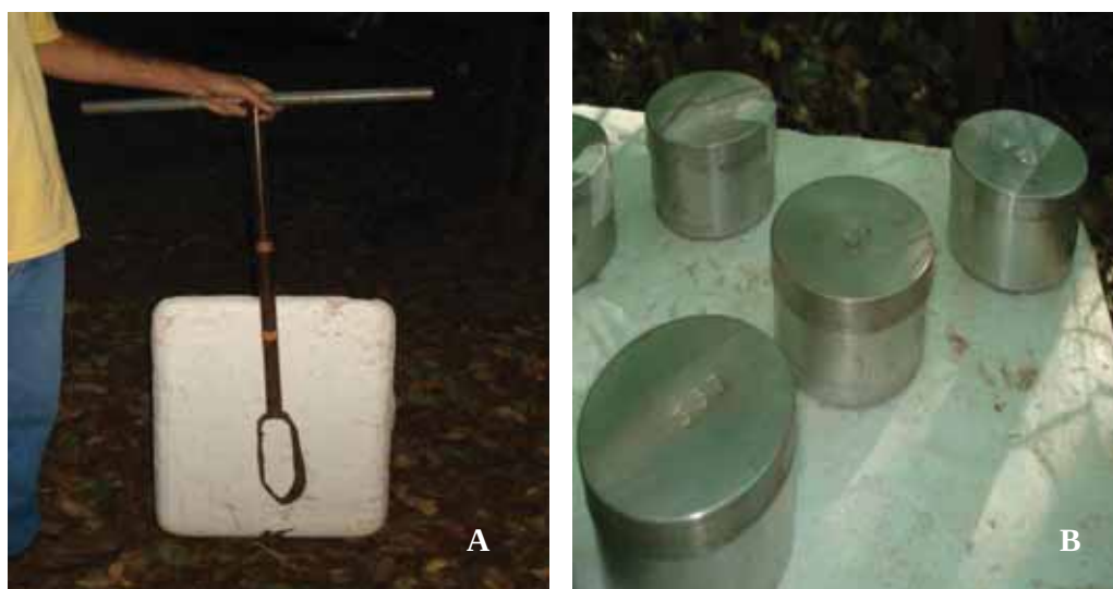
Figura 3. Trado holandês para retirada das amostras de solo (A), Latas numeradas para armazenar as amostras de solo (B).
