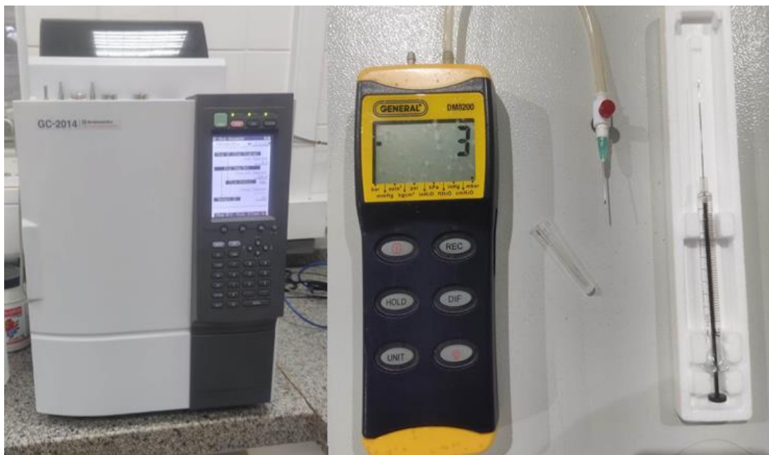
Figura 8. Equipamentos para amostragem do biogás. A esquerda o cromatógrafo a gás com coluna TCD e a direita o manômetro e a seringa específica para medição de gases.
