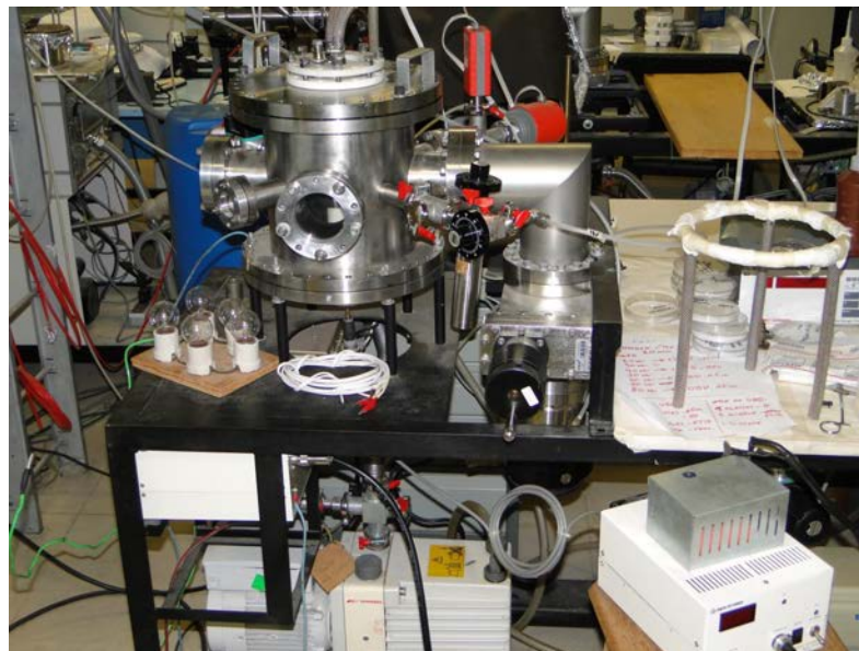
Figura 7 Foto do sistema de polimerização em plasma.
