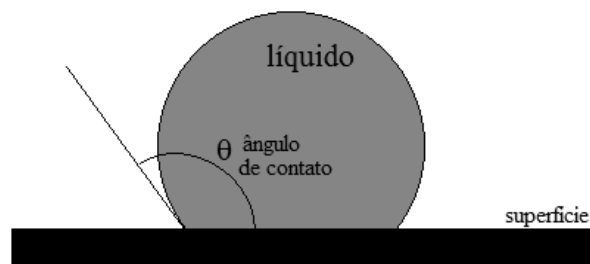
Figura 10 Ângulo de contato entre o líquido e a superfície.
