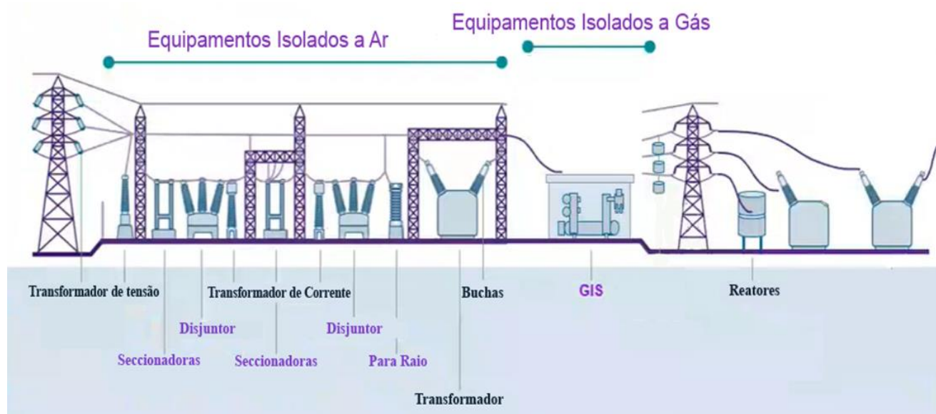
Figura 9. Equipamentos principais de alta tensão integrados de uma subestação
