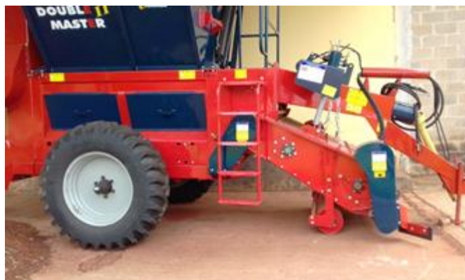
Figura 13: Colhedeira móvel, com tração externa, desenvolvida pelas Indústrias Colombo
