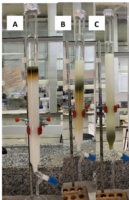
Figura 5. Filtração em gel Sephadex LH-20 (25-100 \mu\text{m} Sigma-Aldrich®), no início da filtração (A), durante (B) e ao fim (C).
