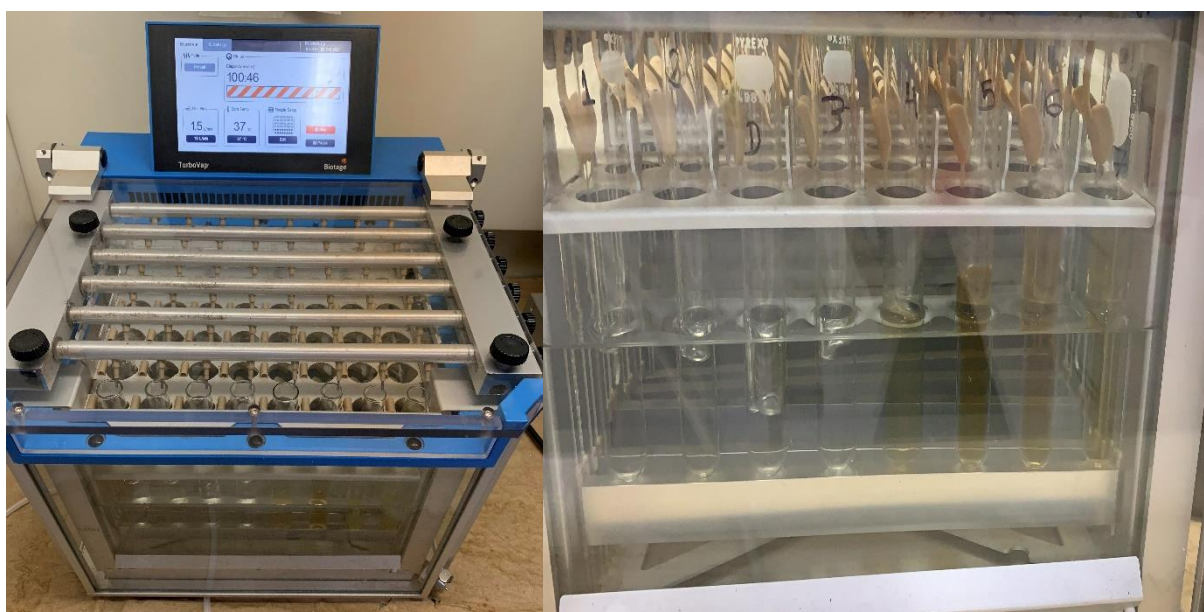
Figura 6. Secagem das frações coletadas por Sephadex LH-20, por TurboVap®.
