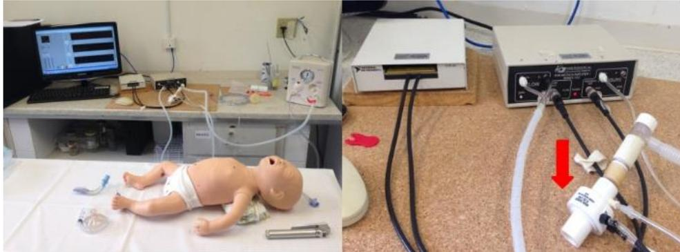
A seta mostra o pneumotacógrafo acoplado ao ventilador manual em T e a um sistema informatizado de aquisição de dados, que são transmitidos ao computador.
