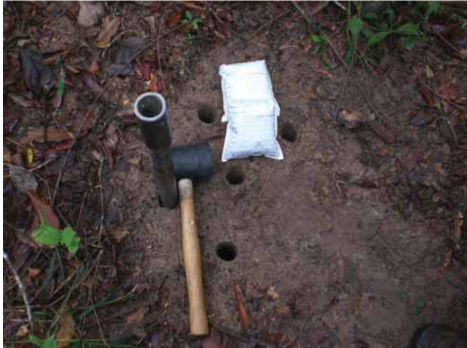
Figura 4a – Coleta de solo em duas profundidades utilizando-se trado do tipo “sonda”.
