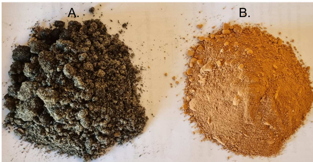
Figura 2: CROL antes (A) e depois (B) de ser calcinado.
