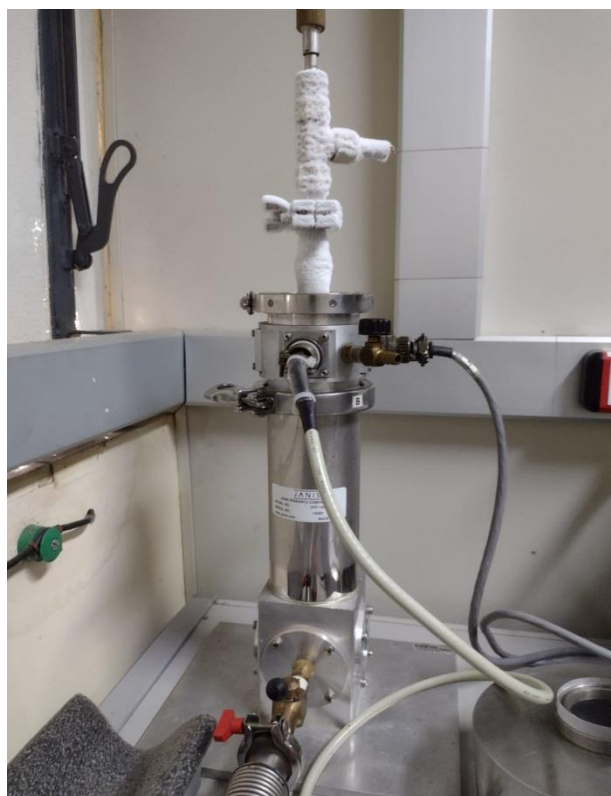
Figura 8 – Criostato Janis utilizado para a caracterização elétrica em função da temperatura.
