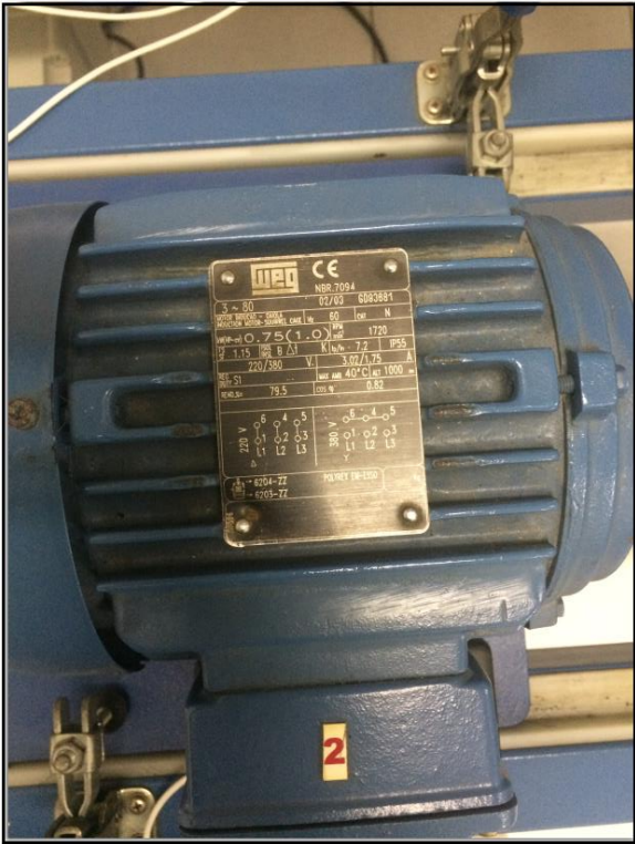
Fotografia 1 - Dados de placa do motor
