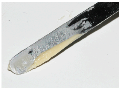
Atenção, pois diferentemente do CIV convencional, o material de alta viscosidade apresenta consistência final cremosa.
