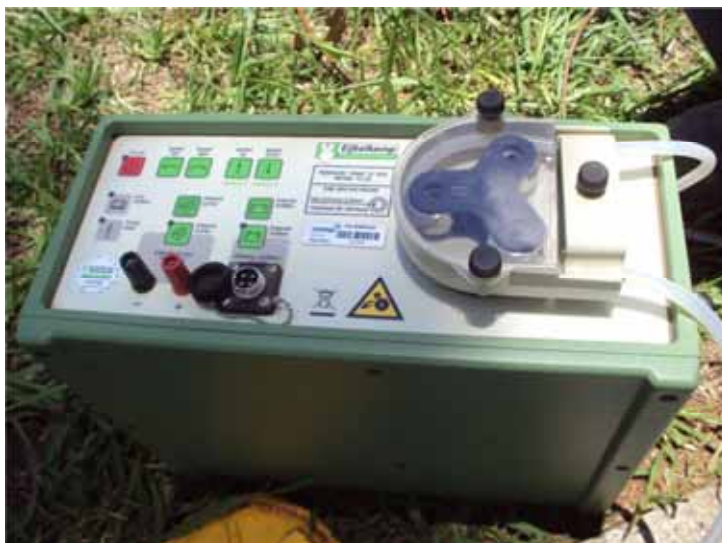
Figura10: Bomba peristáltica para extração de gás do interior do poço de monitoramento.
