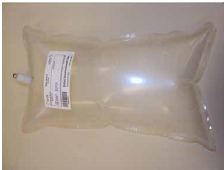
Figura 11: Tedlar bag de 5 litros destinado ao armazenamento do gás amostrado.
