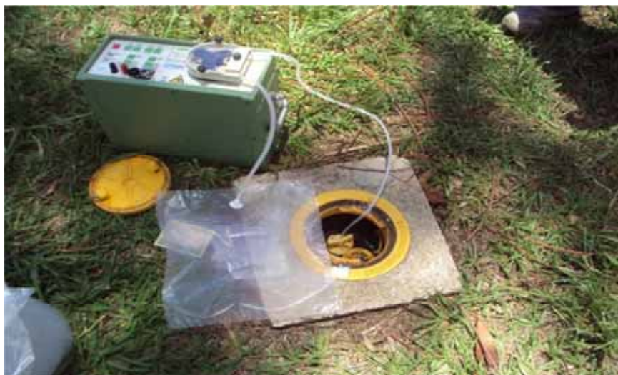
Figuras 15: Conexão do Tedlar bag à bomba peristáltica e ao poço
