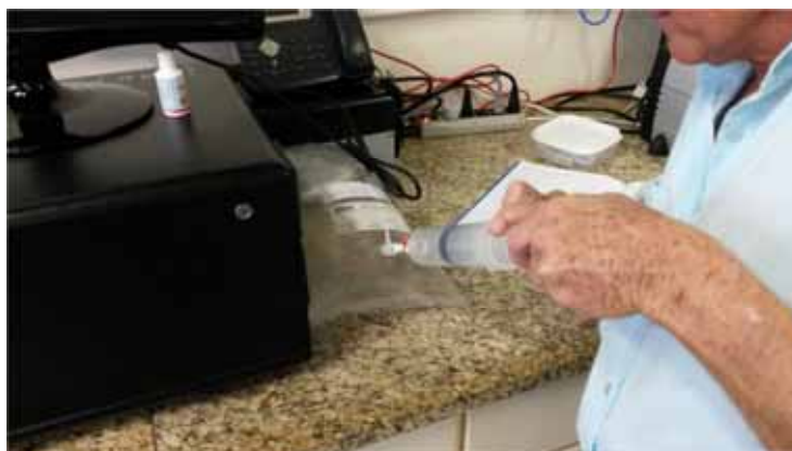
Figura 19: Coleta de amostra gasosa com o auxílio de uma seringa
