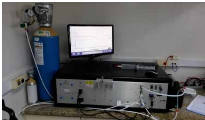
Figura 18: Espectrômetro de absorção laser em cavidade ressonante
