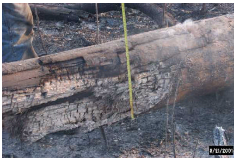
Figura 4.11 – Incandescência na lateral de tronco com 25 cm de diâmetro.
