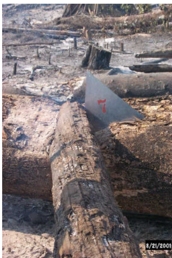
Figura 4.40 – Fotografia do tronco nº. 7, focalizando a região (cruzamento) com oscilações entre chama e incandescência.
