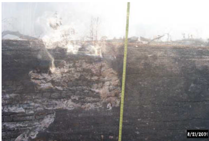
Figura 4.10 – Propagação da onda de incandescência na casca de um tronco de 53 cm de diâmetro.
