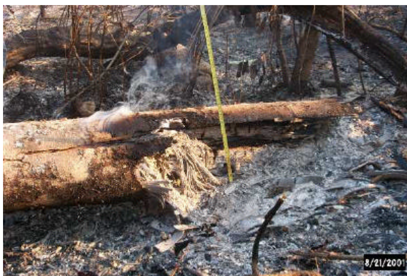
Figura 4.7 – Onda de incandescência propagando-se apenas na metade inferior do tronco.
