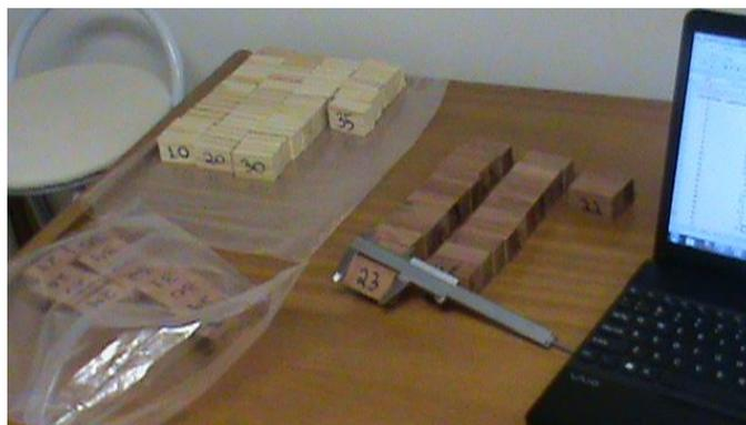
Figura 10: Medição da massa dos corpos de prova a 12% de umidade.
