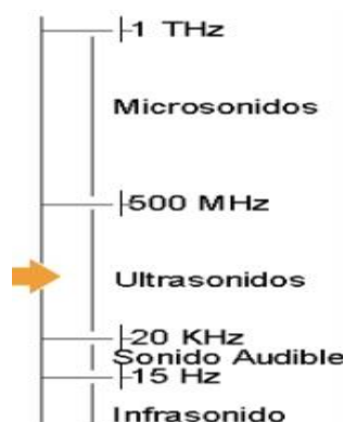
Figura 25 - Escala demonstrativa das diferenças entre as frequências dos sons, na escala Hertz. Fonte: https://www.ufrgs.br/biofisica/ecografia.pdf
