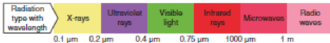
Figura 1 - Espectro eletromagnético da radiação infravermelha. Fonte: SOROKO MOREL (2016).
