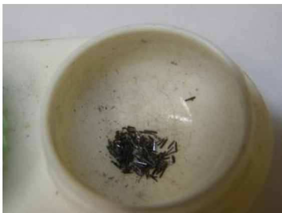
Figura 19: Amostras de ludwigita homometálica de ferro. Figura extraída da referência [22].
