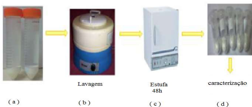
Figura 24 - (a) Solução resultante após centrifugação; (b) lavagem das nanopartículas; (c) secagem das nanopartículas; (d) obtenção das nanopartículas.
