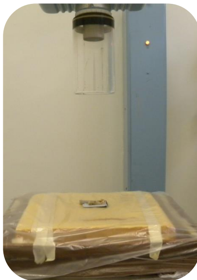
Figura 23: Distância foco-filme de 40 cm.
