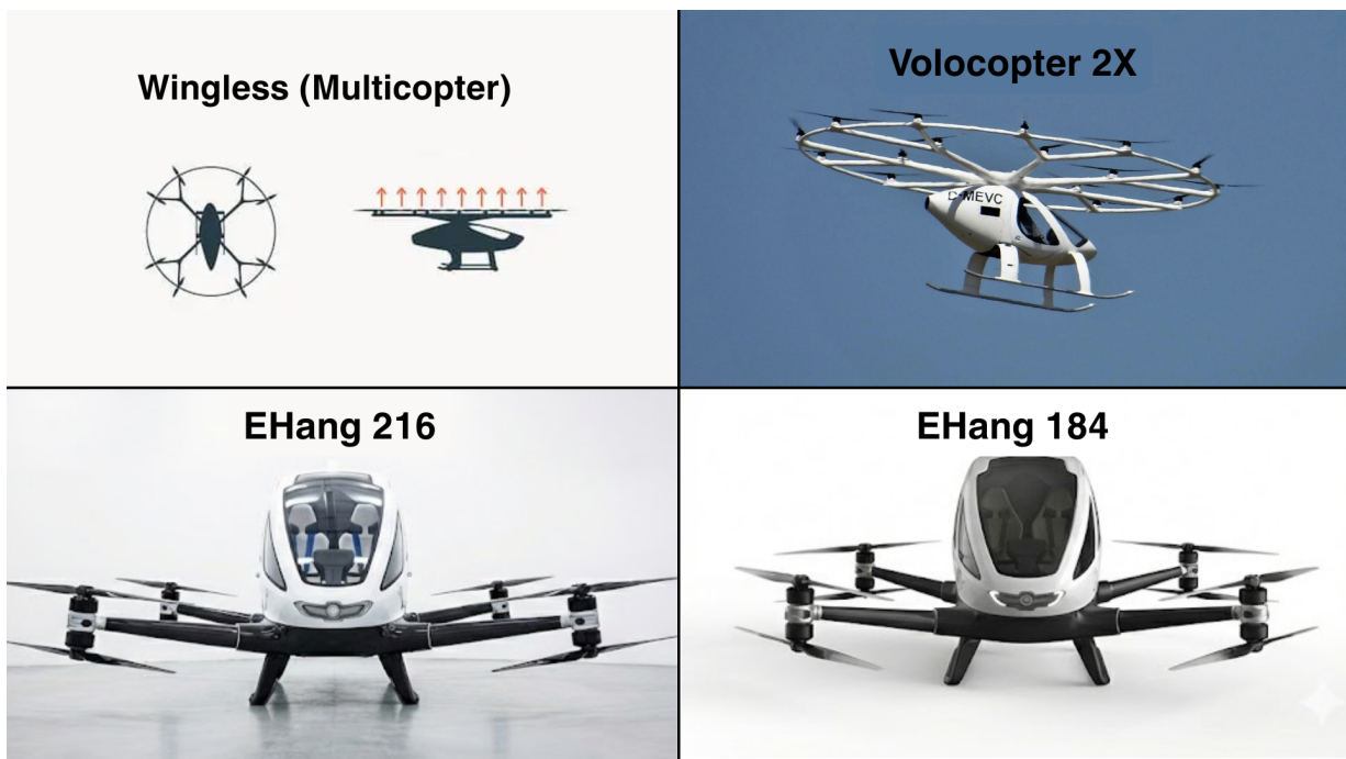
Figura 6 – Configuração Wingless (Multicopter) : (a) Diagrama ilustrativo da arquitetura; (b) Volocopter 2X em voo; (c) EHang 216; (d) EHang 184.
