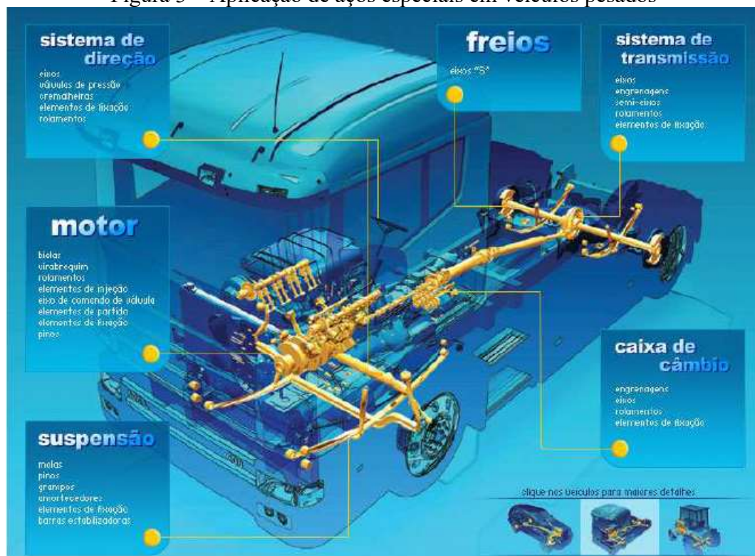
Figura 3 – Aplicação de aços especiais em veículos pesados
