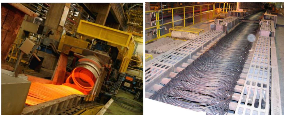
Figura 18 – Formado de espiras Stelmor para fio máquina
