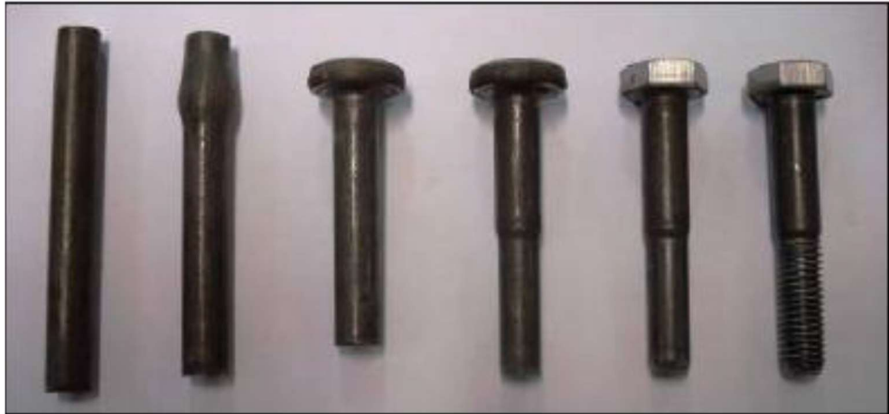
Figura 7 – Etapas do processo de conformação do parafuso partindo de um arame
